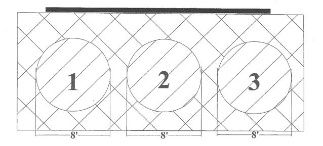
1 - 12,000 GAL GASOLINE 2 - 6,000 GAL GASOLINE 3 - 6,000 GAL GASOLINE
